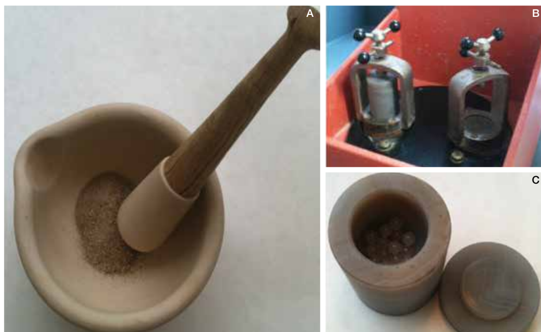
Figura 3.21 Trituración y homogeneización de una muestra de suelo. (A) Mortero. (B) Recipiente ágata en molino comercial. (C) Recipiente de ágata con bolas para contribuir a la pulverización y homogeneización de la muestra de suelo. (© Hilary Kennedy, UWB)
