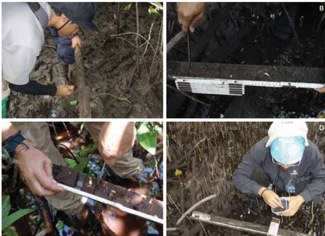
Figura 3.15 Recolección de muestras de suelo con una barrena de cara abierta. (A) Remoción de suelo de la cara de la barrena. (B) Medición y marcación de los intervalos de profundidad. (C) Corte de una muestra. (D) Extracción de la muestra de la barrera y colocación en un recipiente numerado. (© Boone Kauffman, OSU)
