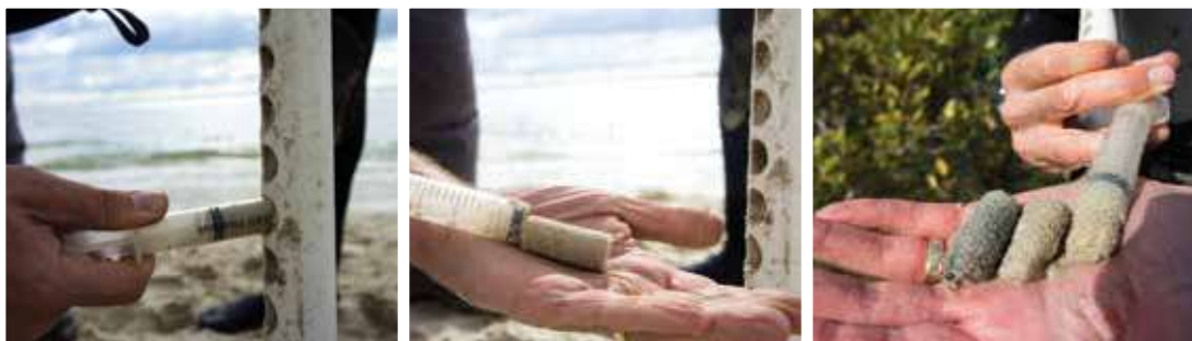
Figura 3.12 Los núcleos se recolectan con un nucleador con puertos de muestreo preperforados. Las muestras de los núcleos se obtienen con jeringas de polietileno sin punta (© Sarah Hoyt, CI)
