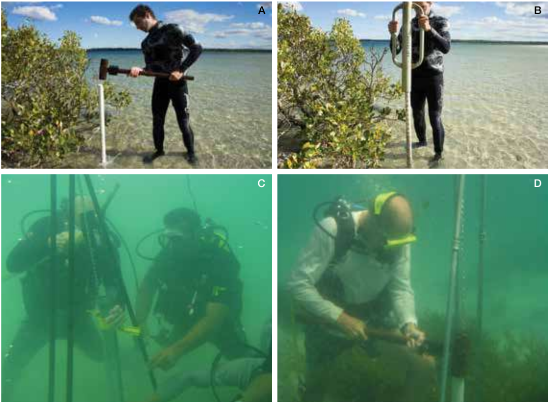
Figura 3.7 Demostración del método utilizado para que el nucleador penetre el suelo en praderas de pastos marinos. (A) Un mazo en aguas poco profundas (© Sarah Hoyt, CI). (B) Un hincapostes en aguas poco profundas (© Sarah Hoyt, CI). (C y D) Un mazo en aguas profundas (© James Fourqurean, FIU)
