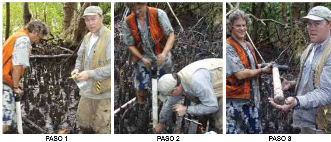
Figura 3.5 Obtención de un núcleo de suelos con un nucleador (© Boone Kauffman, OSU)
